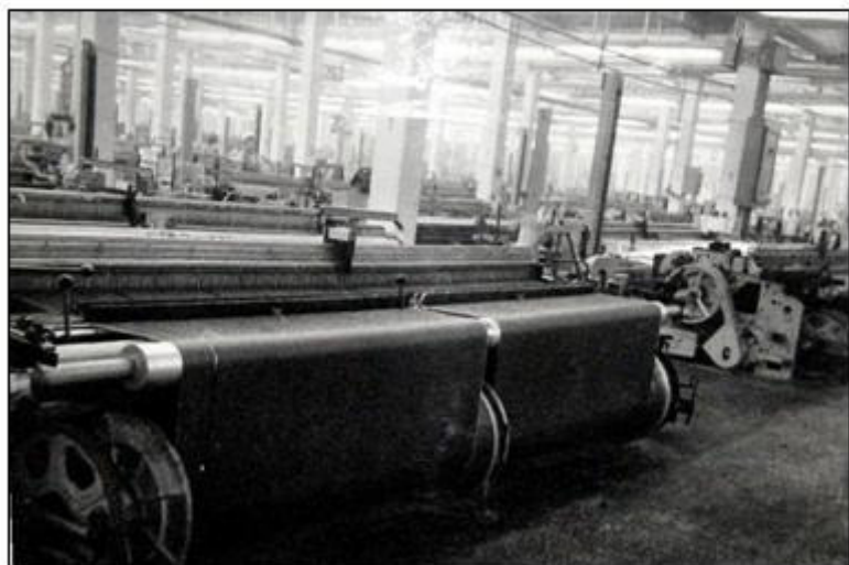
Барнаульский меланжевый комбинат был оснащен новейшими отечественными станками. На верхнем снимке - прядильно-крутильные машины выполняющие 4 операции: прядение, трощение, кручение и наматывание нити на барабаны. На нижнем снимке - ткацкие станки. Фото 1967 г. из фонда музея школы № 31.
