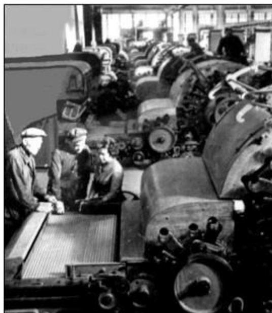
Монтаж кордочесальных аппаратов на заводе асботехнических изделий. Фото 1966 г. из фотохроники ТАСС № 653579.
