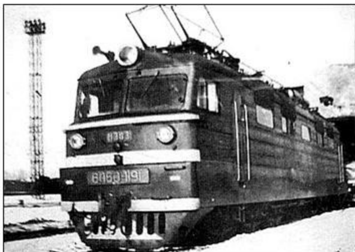
В 1963 г. на Алтайском отделении железной дороги запущены в работу электровозы ВЛ-60 переменного тока на ртутных выпрямителях.
